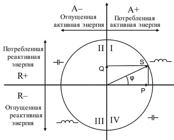
Рисунок 2 – Диаграмма распределения активной и реактивной мощности (энергии) по квадрантам.
